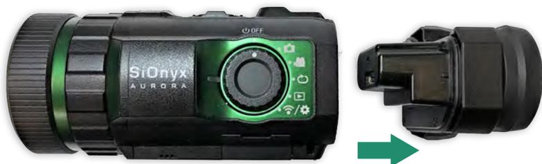
3. Premere la linguetta sul lato sinistro della batteria ed estrarre la batteria.
